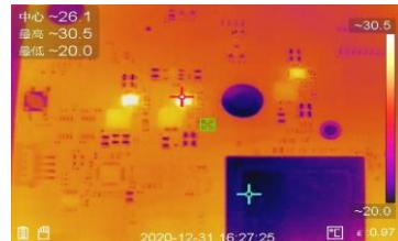
支持多种伪彩显示模式，搭配点、线、区域测温功能，直观呈现温度分布，便于快速定位异常热点，提升工业检测效率。
