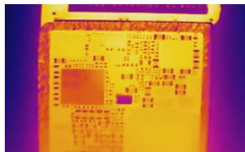
支持快门校正、光学透过率矫正及3D降噪功能，有效提升复杂环境下图像质量与测温可靠性
